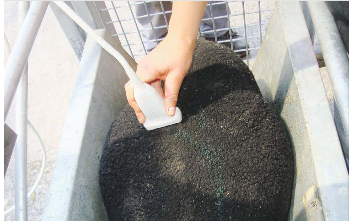
Mit einem Ultraschallkopf wird die Sonde auf die Haut beim dritten Lendenwirbel gesetzt. Mit dem Scanner wird der Lendenmuskel (Kotelett und Filet) im Querschnitt gemessen.
